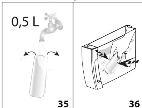
4. Достаньте бачок (A17) из машины и заполните его водой.
