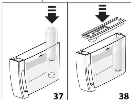
После установки фильтра следует сообщить о его наличии прибору.
